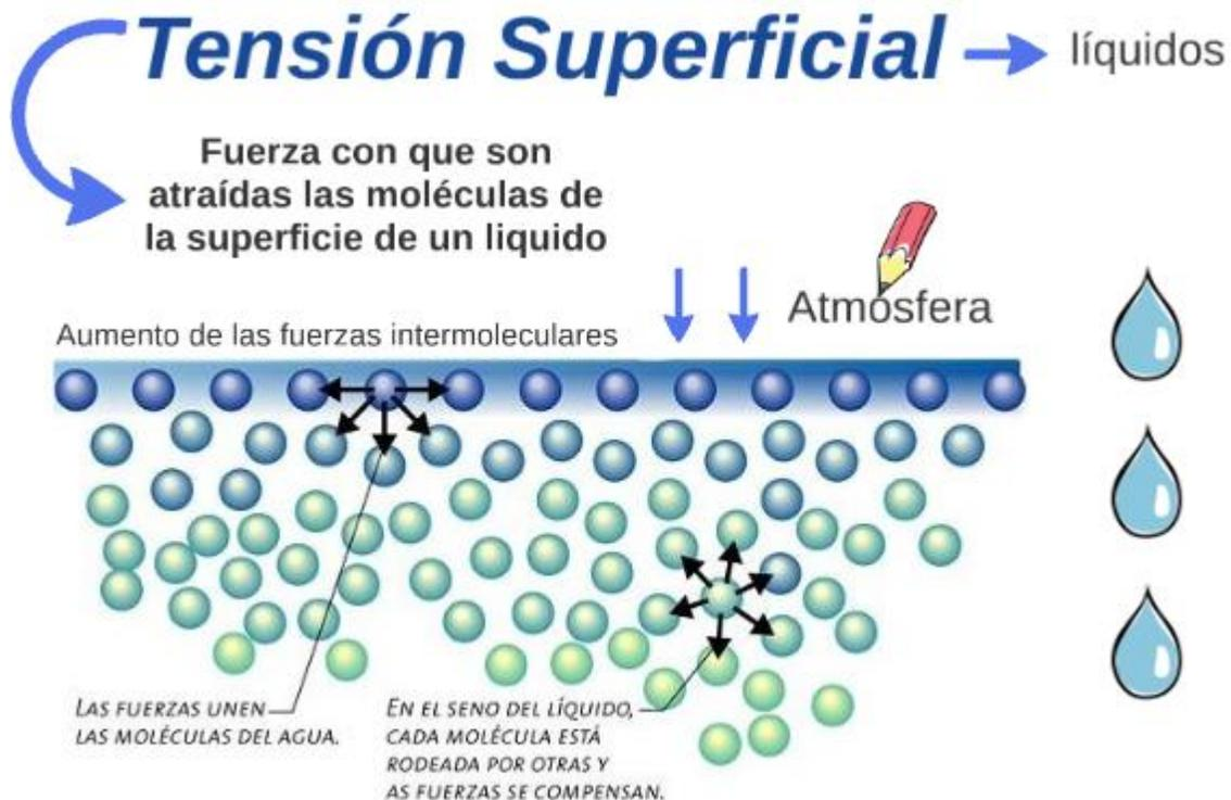
La tensión superficial puede ser cuantificada y evaluada como una magnitud constante para un líquido determinado. Una forma de ponerla en evidencia es por medio de un dispositivo en forma de arco como muestra la figura.
